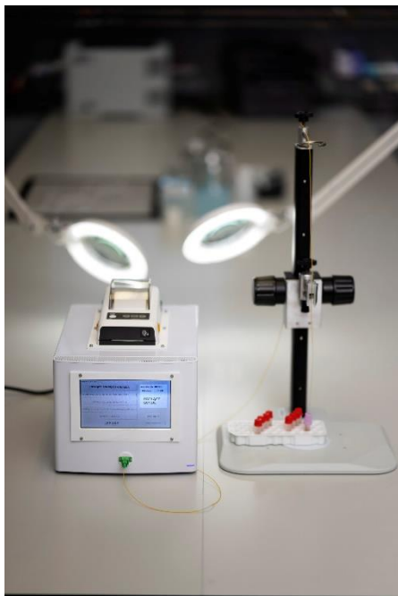
Fot. inPROBE® – urządzenie detekcyjne oraz mikrosonda optyczna (biosensor). Źródło: Forbes Polska
